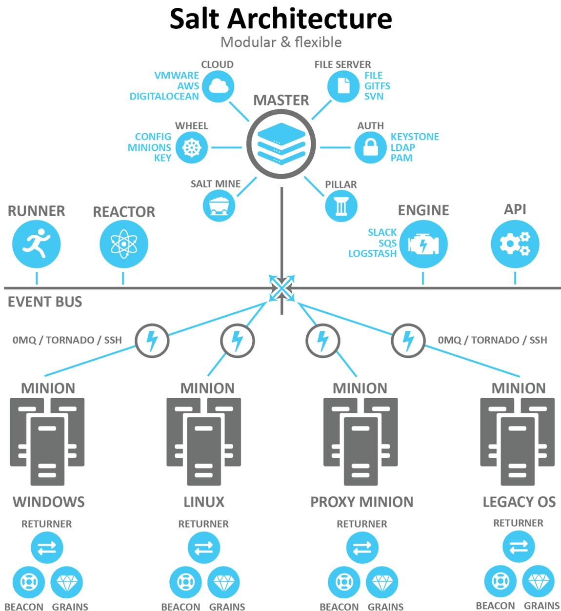
Salt presenta una arquitectura cliente-servidor con un bus de comunicación (ZeroMQ) en la cual existen agentes que inician dos conexiones seguras persistentes con clave pública contra el servidor y la mantienen establecida para una comunicación bidireccional, en la cual pueden recibir comandos (método "push") o tareas a ejecutar y posteriormente remiten/obtienen (método "pull") datos hacia/desde el servidor, también puede soportar comunicación a través de canales como ssh.
