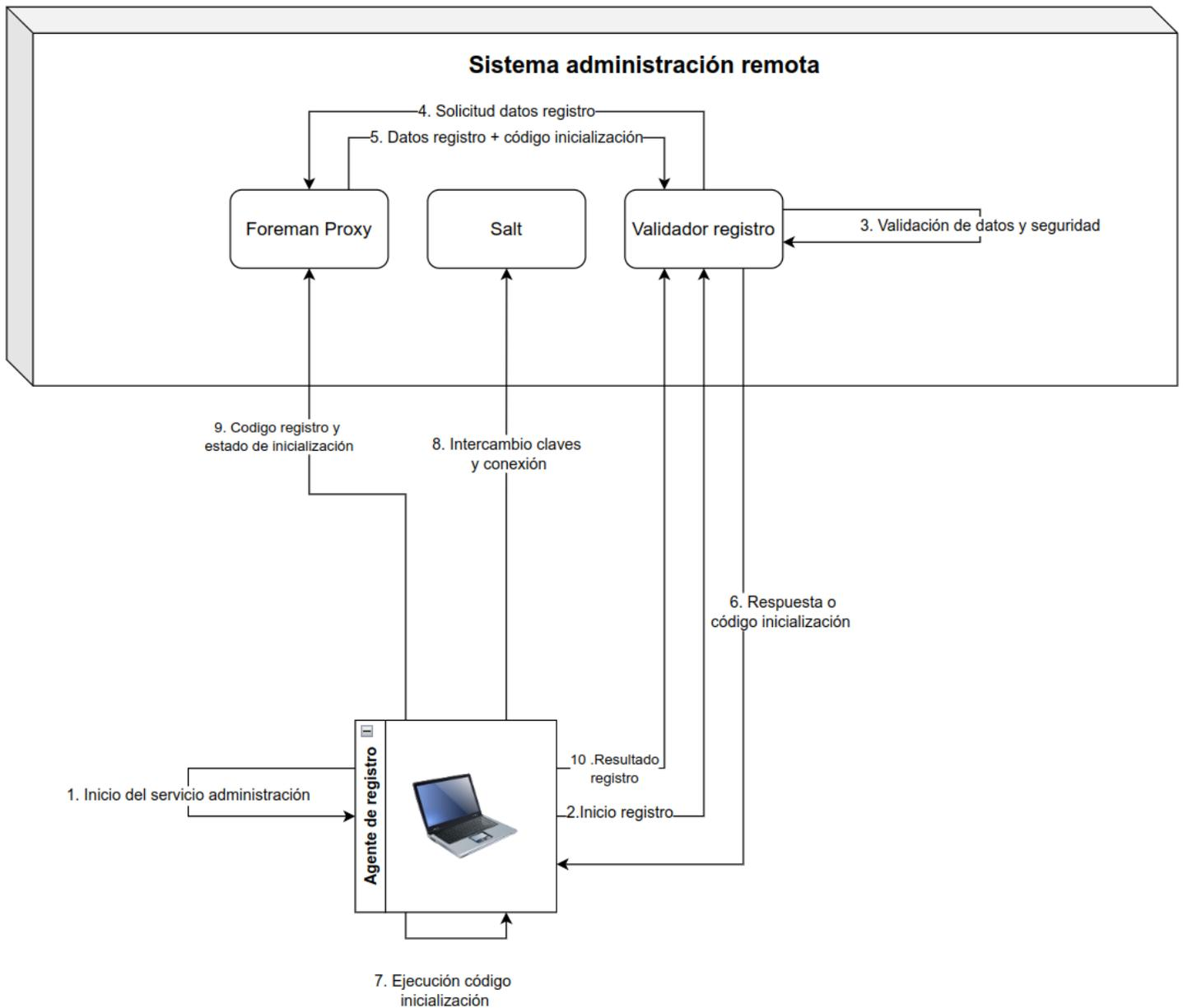
Diagrama del servicio para realizar una validación previa y realizar el registro de un equipo en el sistema Foreman:
