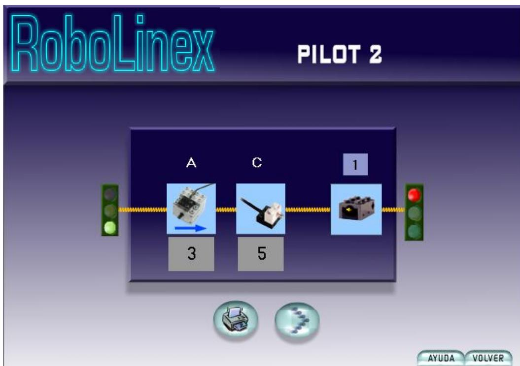
La plantilla del Nivel 2, por defecto, enciende el motor situado en la salida A hasta la mitad de su potencia y enciende la lámpara C a su máxima potencia hasta que se presiona el sensor de entrada 1.
