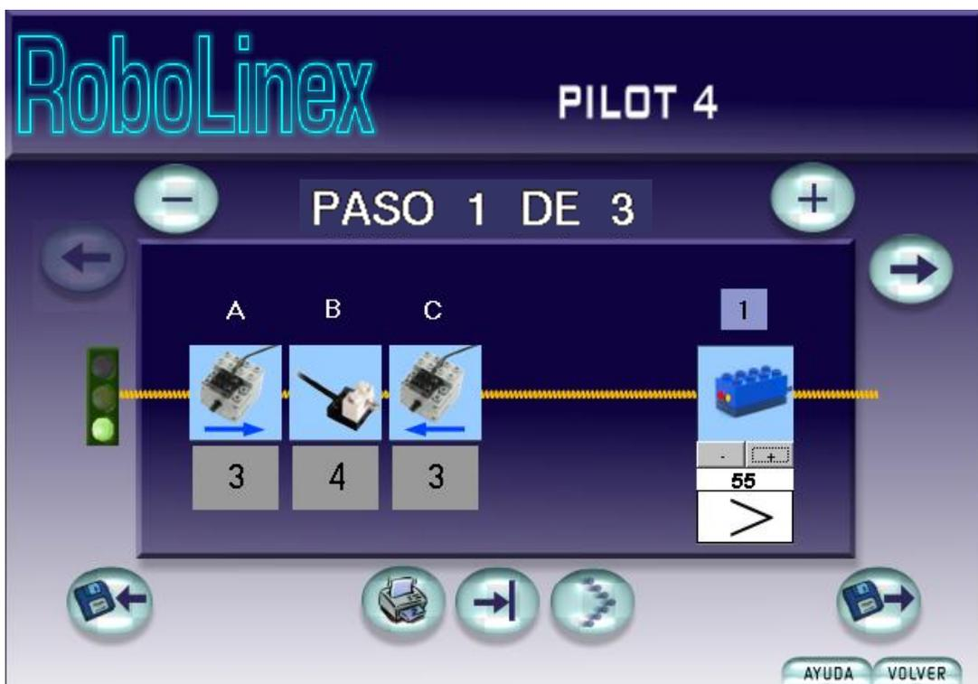
Cuando se inicia el programa, los pasos 1 y 2 enciende la lámpara B mientras que los motores A y C giran en sentidos opuestos. Los motores y la lámpara permanecen activos hasta que el sensor de luz en el puerto de entrada 1 indica que el porcentaje de luz es superior a 55.
