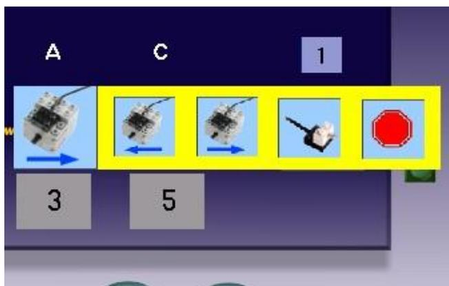
**Nota:** Al seleccionar los motores o las lámparas, el bloque RCX comienza a enviar potencia hacia los puertos de salida, aunque no haya ninguna carga conectada. Asegúrese de conectar correctamente las cargas a las salidas del RCX.
