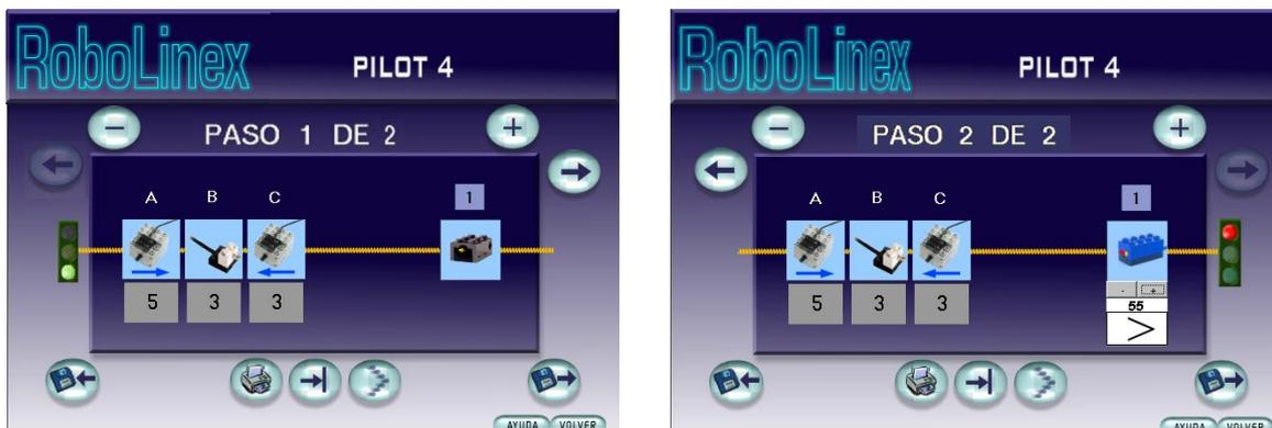
*Paso 1:* Encender el motor A, la lámpara B y el motor C hasta que se presione el sensor del puerto 1.
