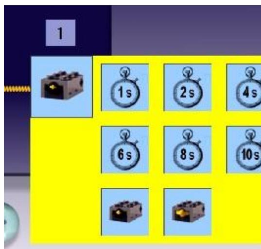
El comando del sensor de contacto espera que sea soltado o que se presione el botón. El icono en el que aparece el sensor con el botón presionado hará que el programa espere a que presionemos el sensor. El icono en el que aparece el botón sin presionar hará que el programa espere a que soltemos el sensor.
