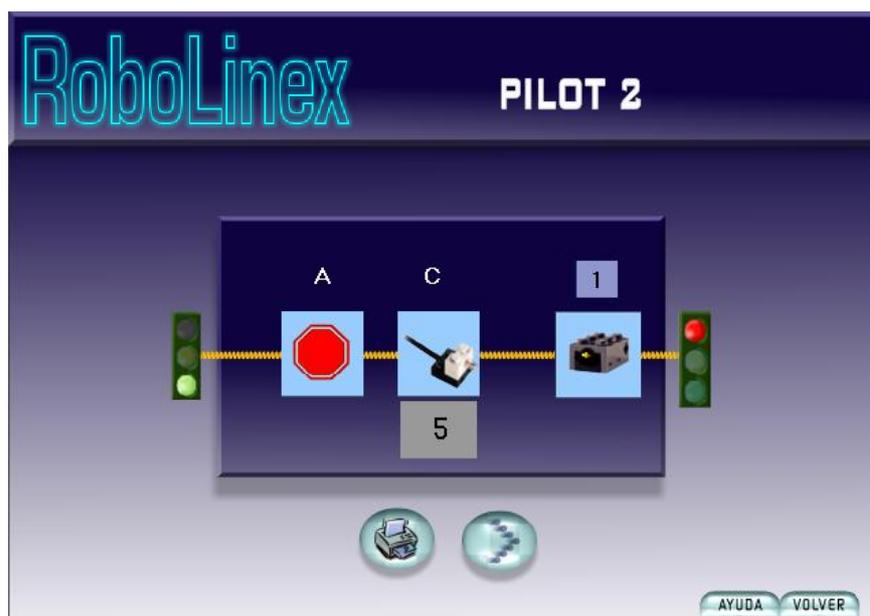
Conecte una lámpara al puerto C de las salidas y un sensor de contacto al puerto 1 de las entradas del RCX, utilizando los cables conectores. Descargue el programa al RCX e inicie el programa, pulsando el botón verde (RUN), en el bloque de control RCX. Cuando esté el programa funcionando, la lámpara debe permanecer encendida hasta que se presione el sensor de contacto.
